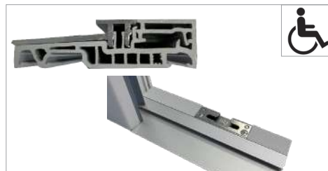
Seuil aluminium avec rupture de pont thermique 20 mm avec gâche encastrée dans le seuil
